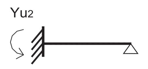
Al ser una losa unidireccional, los esfuerzos se calculan con el modelo de barra y no a traves de las tablas de Marcus-Losser
